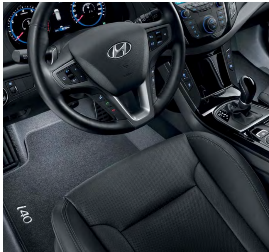
Białe podświetlenie podłogowe LED. Dyskretnie podświetlenie podłogowe w przedniej części kabiny. Eleganckie oświetlenie powitalne automatycznie włączane po otwarciu przednich drzwi i wyłączane po ich zamknięciu. Po uruchomieniu silnika oświetlenie przygasa. Dostępne również dla drugiego rzędu siedzeń. Oświetlenie LED drugiego rzędu dostępne tylko w połączeniu z oświetleniem pierwszego rzędu. 99650ADE00W (pierwszy rząd, modele 2011 i 2015, Sedan, Wagon) 99650ADE10W (drugi rząd, modele 2011 i 2015, Sedan, Wagon)
